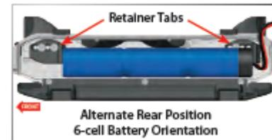
I vani batteria possono essere adattati per accettare molti formati di batterie LiPo. Se si utilizzano batterie che sono molto spesse, potrebbe essere necessario rimuovere la molla dal vano batterie.
