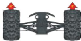
7. Operate delicatamente sull'acceleratore per assicurarsi di avere una corretta rotazione delle ruote in avanti e in retromarcia, e che il motore si arresti quando il grilletto è in posizione neutra **ATTENZIONE:** Non accelerare a pieno gas (e non ecceder comunque) ne in avanti ne indietro, mentre il modello è con le ruote sollevate da terra.
